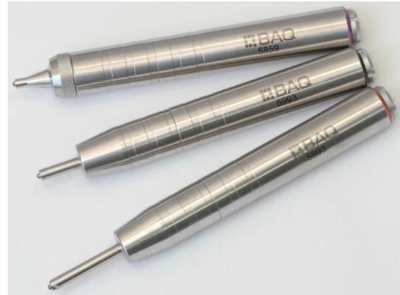
Illustration 3: Sonde de test UCI standard (en haut); version SL (centre); version SL-L (en bas).
