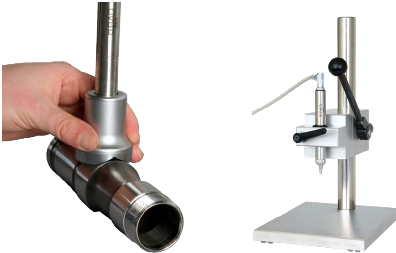
Illustration 14: Outil pour positionnement (à gauche) et support de mesure de précision (à droite)
