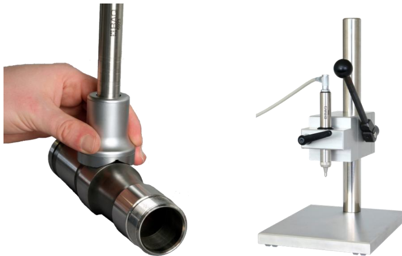
Figura 14: Aplicación de un soporte de apoyo (izquierda) trípode para mediciones más precisas (derecha)
