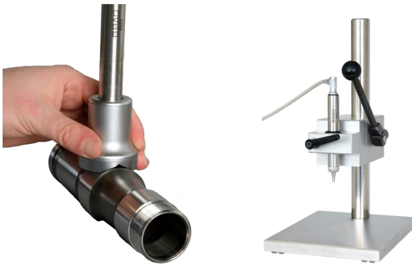
Abbildung 14: Verwendung von Aufsetzhilfe (links) und Präzisionsmessstativ (rechts)
