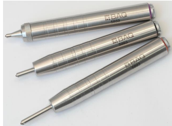
Abbildung 3: Standard UCI-Prüfsonde (oben); SL-Sonde (Mitte); SL-L-Sonde (unten)
