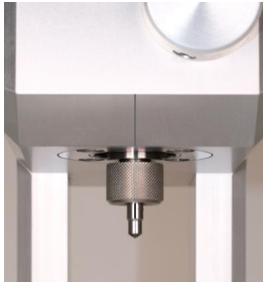
Abbildung 2: Ausrichtung des Indenters
