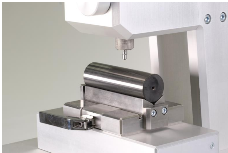
Abbildung 8: Prisma zur Aufnahme zylindrischer Proben
