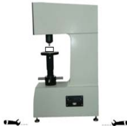
Abbildung 3-4 Einnivellieren des Gerätes
