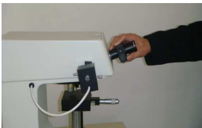
Abbildung 3-4 Installieren des Messmikroskops
