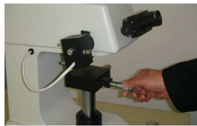
Abbildung 3-5 Einsetzen des Kreuztischs
