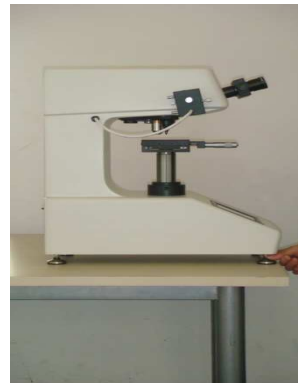
3-3(c) Justieren Sie die Maschinenfüße, damit das Gerät Horizontal steht.
