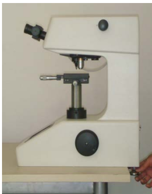
3-3(a) Bringen Sie die Maschinenfüße hinten zuerst an
